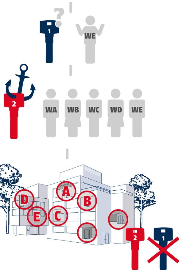
**i** Eine Schließanlage besteht aus mehreren Schließzylindern, die mit unterschiedlichen Schlüsseln bedient werden können. Damit können individuelle Schließberechtigungen vergeben werden. Beispielsweise haben alle Mieter mit ihrem Schlüssel Zugang zum Hauseingang, zur Tiefgarage und zum Kellergang. Zusätzlich kann jeder Mieter mit dem gleichen Schlüssel aber nur seine Wohnungstür, seinen Briefkasten und seinen Keller aufschließen.
