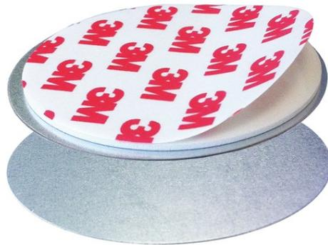
Il kit di fissaggio con magnete è un'alternativa ideale per un montaggio del rilevatore di fumo senza viti e tasselli. Il kit è composto da una lastra autoadesiva per il fissaggio a soffitto, nonché da un elemento di attacco per il fissaggio al rilevatore di fumo. I due elementi magnetici mantengono il rilevatore al suo posto. Pertanto è possibile effettuare un montaggio rapido e semplice senza forature e strumenti aggiuntivi.
