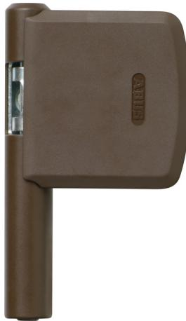
Die Fenster-Zusatzsicherung ABUS FAS101 dient der Sicherung der Scharnierseite. Die Griffseite sollten Sie gesondert absichern. Beim Öffnen des Fensters dreht FAS101 einfach mit, vor dem Kippen muss der Sicherungsbolzen entriegelt werden. Nach Kippstellung des Fensters muss der Bolzen dann wieder eingedrückt werden. Montiert wird die Scharnierseitensicherung auf dem Fensterflügel und dem Rahmen. Dank ihrer schmalen Konstruktion kann FAS101 auch bei engen Einbauverhältnissen eingesetzt werden.
