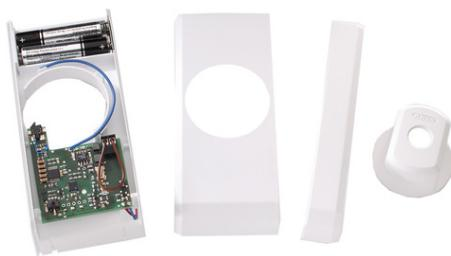
Auf den ersten Blick ist die rein mechanische Fenstersicherung FTS 96 von der elektronischen Funk-Fenstersicherung FTS 96 E nicht zu unterscheiden. Mit dem Funk-Nachrüstset präparieren Sie die mechanische Fenstersicherung FTS 96 für den Einsatz mit der Secvest 2WAY. Im Funk-Nachrüstset sind enthalten: Ein neuer Drehknopf, neue Abdeckhaube, Schloss und Schlosskasten, sowie Batterien und ein Elektronikaufsatzz. Das Umrüsten bereits montierter FTS 96 Fenstersicherungen ist jederzeit möglich.
