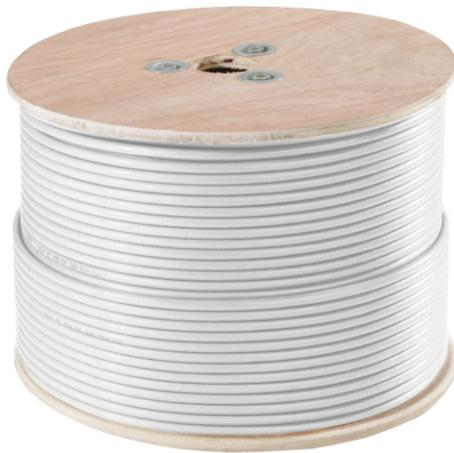
Mit dem Video-Kombi-Kabel verbinden Sie einzelne Komponenten miteinander und sorgen für eine gute Übertragung der Daten. Über die beiden integrierten Litzen für Stromversorgung ( $2 \times 0,75\text{mm}^2$ ) versorgen Sie die angeschlossenen Geräte mit Energie. Der Kabelwiderstand beträgt 75 Ohm. Das Video-Kombi-Kabel gibt es in einer Länge von 50 m (KA9002), 100 m (KA9001) und 250 m (KA9000).
