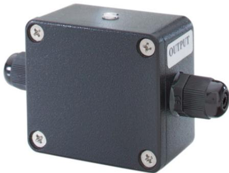
Die Tag/Nacht Schaltbox ist ein Zubehör der diskreten und semidiskreten MEGA-LED XL IR-Strahler (TV6855, TV6856, TV6898, TV6899). Sie misst die Helligkeit in der Umgebung der Kamera und schaltet den IR-Strahler bei einer Lichtstärke unterhalb 10 Lux ein. So werden die IR-Strahler erst aktiv, wenn die vorhandene Beleuchtung für die Kamera nicht mehr ausreichend ist. Dies spart Strom und verlängert die Lebensdauer des Strahlers.
