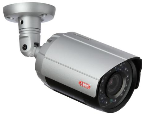
Die IR HD-SDI 1080p Außenkamera liefert Bilder in Full-HD Auflösung und überträgt sie in flüssigen Echtzeit-Bildern (unkomprimiert) über ein Videokabel (Koaxial). Sie speist HD Bilder in 2-Megapixel-Qualität in ein CCTV-System ein, die von einem HD-SDI Rekorder verarbeitet und gespeichert werden. Mittels HDMI-Konverter, können die Live-Bilder auch direkt auf einem HDMI Monitor oder TV-Gerät ausgegeben werden.
