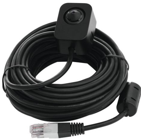
Das Kameramodul in Rechteckform ist ein benötigtes Zubehör für den Dual Flex Encoder IPCS10020. Das Mini-Modul misst nur 27 x 37 x 25 mm (inkl. Gehäuse und Klebepad) und verfügt über ein 8 m Kabel zum Anschluss an den Encoder, welches nach unten weggeführt wird. Mit einem Blickwinkel von 57° bietet das 3,7 mm Nadelöhr-Objektiv einen fokussierten Blick auf ausgewählte Raumbereiche oder in Gänge hinein.
