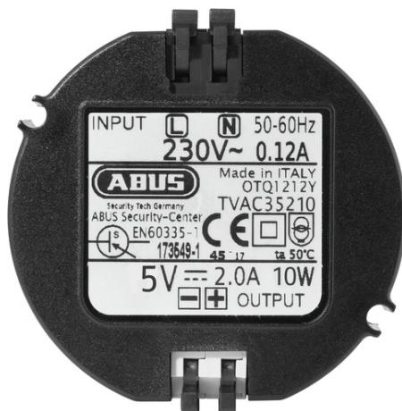
Das stabilisierte Mini-Clip-Einbaunetzteil (230 V AC / 5 V DC, 2 A) dient der Spannungsversorgung Ihrer Videokomponenten. Die Weiterentwicklung mit einer Hebel-Federklemme macht die schnelle Installation ohne Werkzeug oder zusätzliche Klemme möglich. Mit seinen kompakten Maßen eignet es sich besonders gut als Unterputznetzteil zum Einbau in eine 55 mm Unterputzdosen und überall dort, wo wenig Platz für die Stromversorgung vorhanden ist.
