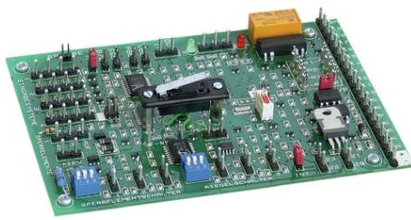
Mit der Auswerteeinheit AE255F lassen sich intelligente Schaltungen für mehr Sicherheit und Komfort realisieren. So lässt sich etwas gezielt festlegen, welche Personen scharf, unscharf oder beide Funktionen schalten dürfen. Es können auch Benutzer angelegt werden, die nur bei unscharfem Zustand Zutritt haben. Daneben lassen sich noch Sonder-Codes für stillen Alarm, intern scharf oder Spezialschlüssel für den Wachdienst anlegen.
