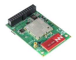
Zusätzliche Übertragung von Alarmmeldungen über das Mobilfunknetz
