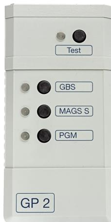
Aktive Glasbruchmeldersysteme reagieren erheblich empfindlicher auf Glasbruch als passive. Es ist notwendig, für jede Geräteart spezielle Prüfsignale zu erzeugen. Deshalb ist das Glasbruchmelderprüfgerät mit verschiedenen Funktionen für aktive und passive Glasbruchmelder ausgestattet. Über eine Piezoscheibe an der Stirnseite des Prüfgerätes wird das Prüfsignal elektromechanisch in die Scheibe übertragen und dort vom Glasbruchmelder ausgewertet.
