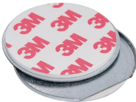
Le kit de fixation à aimant offre l'alternative idéale sans vis ni chevilles au montage de dispositifs d'alarme de fumée. Le kit se compose d'une platine auto-adhésive destinée à être fixée au plafond et d'un socle qui permet la fixation au dispositif d'alarme de fumée. Les deux pièces magnétiques maintiennent le détecteur en place de façon sûre. Il est donc possible d'effectuer facilement un montage rapide et propre sans avoir recours à une perceuse ou à des outils supplémentaires.
