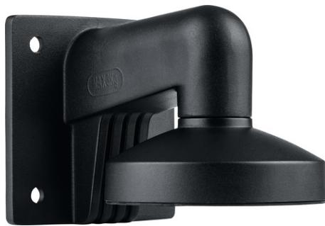
Le support mural est un accessoire en option pour le Mini Dôme IP IPCB44611A, IPCB44611B.CRLFCRLFII sert au montage encastré professionnel de la caméra dôme en position horizontale. La structure robuste en aluminium permet un passage interne des câbles protégé et convient aussi bien à l'intérieur qu'à l'extérieur.
