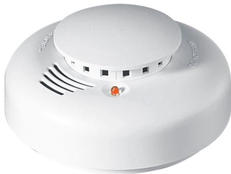
Optischer Rauchmelder mit Streulichtprinzip, Überwachungsfläche: ca. 40 m<sup>2</sup>, Automatik-Reset • Überwachungsfläche: max. 40 qm • integrierte Testtaste • Automatik-Reset nach Alarm • Batterieunterspannungsmeldung • stündliche Senderstatusmeldung • Leuchtanzeige bei Alarm • Prüftaste zum manuellen Selbsttest • Batterielebensdauer: ca. 3-5 Jahre (2x3V Lithium-Batterie - nicht enthalten) • Funkfrequenz: 433 MHz, post zugelassen • Abmessungen (HxØ): 25x138mm, Farbe: weiß
