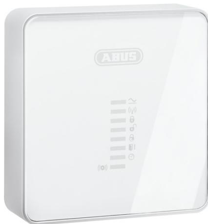
Le module d'information sans fil Secvest 2WAY est un accessoire en option de la Secvest 2WAY. Il utilise un affichage à diodes et différents signaux sonores pour signaler les différents événements et états du signal d'alarme. Les 8 LED du module d'information vous communiquent les états suivants du système :
