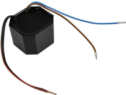
Le mini-adaptateur intégré et stabilisé (230 V AC / 12 V DC, 1 A) assure l'alimentation en courant de vos appareils vidéo. Avec ses dimensions réduites, il convient particulièrement au montage dans des boîtes de 55 mm et partout où il y a peu de place pour des dispositifs d'alimentation.
