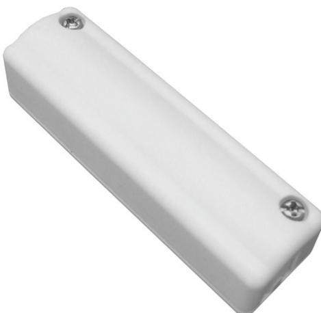
Grâce au répartiteur à visser, vous pouvez réaliser un câblage net. Vous devez installer un répartiteur aux endroits névralgiques de vos locaux surtout lors de l'installation de plusieurs éléments de commande et détecteurs. Le répartiteur à visser à monter en saillie est protégé du sabotage par son contact de couvercle. Il existe en blanc et en marron, avec double raccordements à visser en 5 (VT5000) ou en 8 (VT5100). Les répartiteurs à visser sont en plastique antichoc.
