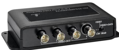
Grâce au distributeur de signal, le signal d'entrée vidéo est transmis sans perte sur quatre moniteurs. L'entrée vidéo permet de connecter votre caméra à un répartiteur de signal. La connexion avec un moniteur se fait par la sortie vidéo. Quatre sorties vidéo BNC sont fournies.
