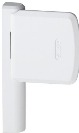
Die Fenster-Zusatzsicherung ABUS FAS101 dient der Sicherung der Scharnierseite. Die Griffseite sollten Sie gesondert absichern. Beim Öffnen des Fensters dreht FAS101 einfach mit, vor dem Kippen muss der Sicherungsbolzen entriegelt werden. Nach Kippstellung des Fensters muss der Bolzen dann wieder eingedrückt werden. Montiert wird die Scharnierseitensicherung auf dem Fensterflügel und dem Rahmen. Dank ihrer schmalen Konstruktion kann FAS101 auch bei engen Einbauverhältnissen eingesetzt werden.
