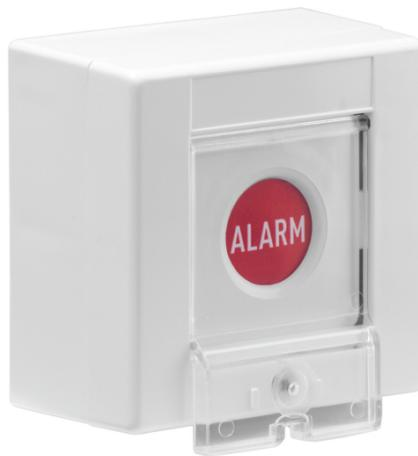
Mit dem Überfalltaster lösen Sie zuverlässig einen Überfallalarm aus, wenn Sie Hilfe benötigen. Den Überfalltaster können Sie als Stand-Alone Gerät einsetzen, oder in die Einbruchmeldeanlage integrieren. Der Taster ist sabotageüberwacht. Für den Überfall- und den Sabotagealarm steht Ihnen ein NO- oder ein NC Kontakt zur Verfügung. Der Überfalltaster ist VSÖ und VdS C zertifiziert.
