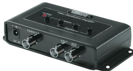
Mit dem Signalverstärker verstärken Sie das Videoeingangssignal und übertragen es über weite Distanzen. Die Verbindung erfolgt mittels Koaxialkabel (RG59): vom Videoeingang der Kamera zum Signalverstärker und vom Videoausgang des Signalverstärkers zu einem oder zwei Monitoren. Dabei beträgt die maximale Distanz zwischen Signalverstärker und Monitor 1000 Meter. Feineinstellungen wie Helligkeit und Bildschärfe werden direkt am Signalverstärker vorgenommen.
