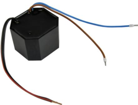
Das stabilisierte Mini-Einbaunetzteil (230 V AC / 12 V DC, 1 A) dient der Spannungsversorgung Ihrer Videokomponenten. Mit seinen kompakten Maßen eignet es sich besonders gut als Unterputznetzteil zum Einbau in eine 55 mm Unterputzdose und überall dort, wo wenig Platz für die Stromversorgung vorhanden ist.
