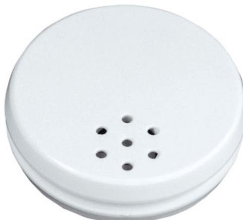
Der ABUS Wassermelder ist ein technischer Melder. Er reagiert auf Wasser und andere Flüssigkeiten. Sobald die Fühler des Melders mit Wasser in Berührung kommen, alarmiert er über einen integrierten Signalgeber. So können Schäden, die durch Rohrbrüche oder geplatzte Wasserschläuche von Wasch- oder Spülmaschinen entstehen, detektiert und durch schnelles Eingreifen verhindert werden.
