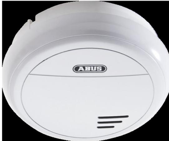
Intelligente Alarmkette zur effektiven Warnung vor Feuer und Rauch Der optische ABUS Funk-Rauchwarnmelder reagiert auf sichtbare Rauchpartikel innerhalb seines Erfassungsbereiches. Gelangt Rauch in die Messkammer des Rauchwarnmelders, sorgt der Piezo-Alarmgeber für die Auslösung eines lautstarken Alarmsignals mit 85 dB Schalldruck.
