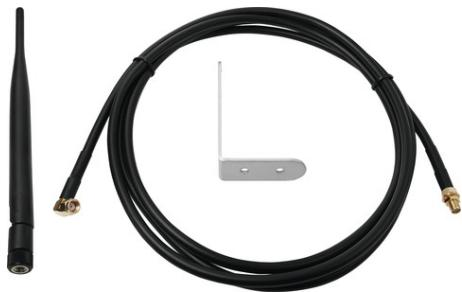
Dieses Komplettset mit 5 dB Antenne, Wandhalter und 2 m Kabel ist ideal zur Signalverstärkung und Reichweitenerhöhung für Funk- und WLAN-Kameras. Der robuste Wandhalter sowie das wettergeschützte Kabel und die wettergeschützte Antenne ermöglichen eine problemlose Montage. Die Antenne ist passend zu allen RP-SMA-Anschlüssen mit einem Feingewinde (~45 Windungen pro Zoll). Passend zu: TVAC14010, TVAC15010, TVAC1601x, TVAC18010, TVAC19x00, PPIC3xxxx, PPDF1xxxx.
