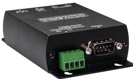
Bei diesem Schnittstellenkonverter handelt es sich um einen seriell-IP-Konverter, auch Terminal Server oder Device Server genannt. Dieses Produkt ermöglicht Remote-Zugriff, Kontrolle und Management von jeglichen seriellen Geräten über ein IP Netzwerk oder das Internet. Es wird verwendet um serielle asynchrone Daten von einem RS232, RS422 oder RS485 Port in TCP/IP oder UDP Pakete zu konvertieren, sodass eine authentische serielle Kommunikation über das Ethernet ermöglicht wird.
