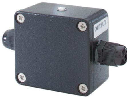
La boîte de commutation jour/nuit est un accessoire discret et semi-discret des détecteurs IR XL (TV6855, TV6856, TV6898, TV6899) qui mesure la luminosité ambiante de la caméra et allume le détecteur IR dès que l'éclairage est inférieur à 10 lux. Ainsi, les détecteurs IR ne sont activés que si l'éclairage existant devient insuffisant pour la caméra. Cette fonction permet une économie de courant et prolonge la durée de vie du détecteur IR.
