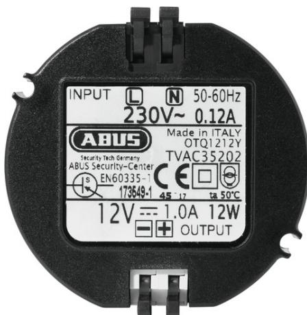
Le minibloc d'alimentation à clip encastré stabilisé (230 V CA/12 V CC, 1 A) sert à alimenter vos composants vidéo. L'amélioration avec pince à ressort et levier offre une installation rapide, sans outil ni pince supplémentaire. Grâce à ses dimensions compactes, il est particulièrement adapté comme bloc d'alimentation encastré à installer dans des boîtes de branchement encastrées de 55 mm et partout où l'espace dédié à l'alimentation est réduit.
