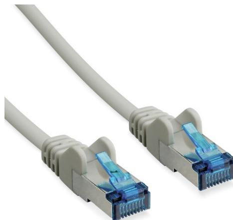
Le câble patch CAT 6A S/FTP PIMF offre une transmission de données fiable pour votre système de vidéosurveillance et peut être utilisé de manière universelle pour relier entre eux tous les appareils compatibles avec le réseau. CAT 6A est conçu pour des taux de transmission rapides allant jusqu'à 10 gigabits par seconde. Les câbles S/FTP PIMF se distinguent en outre par leur double blindage de haute qualité et offrent ainsi une protection contre les perturbations extérieures et la diaphonie.
