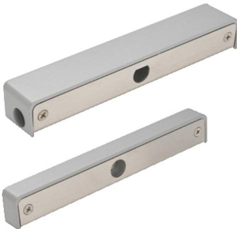
Boîtier en saillie et contre-pièce pour l'élément de blocage AZSE10000 et AZSE10100, si le montage de l'élément de blocage dans le cadre de la porte n'est pas possible. L'aimant pour l'activation du contact magnétique interne SpE, ainsi que le contact magnétique supplémentaire sont compris dans la contre-pièce.
