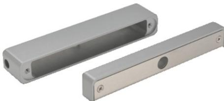
Boîtier en saillie avec contre-pièce spécialement conçu pour le montage sur châssis de l'élément de blocage AZSE10100 et AZSE10000, si le montage de l'élément de blocage dans le cadre de porte n'est pas possible. L'élément de blocage peut ainsi être monté directement dans l'huisserie lorsque la porte s'ouvre vers l'extérieur.
