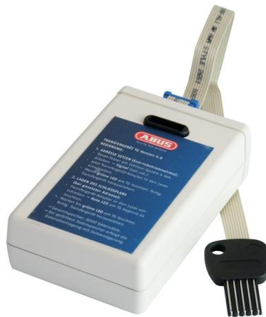
Das Transfergerät ist eine bidirektionale Schnittstelle zwischen Schließmedien und dem Verwaltungs-PC. Dabei werden einerseits Schließmedien in den PC eingelesen oder protokollierte Ereignisse übertragen. In der anderen Richtung werden Schließ- und Scharfschalt-Rechte auf die Schließsysteme übertragen.
