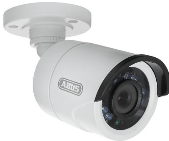
Diese Außenkamera liefert hochauflösende Bilder in HD 720p und wird einfach über ein gewöhnliches, analoges Video-Kombikabel (Bild und Strom) mit einem Rekorder oder Monitor verbunden.
