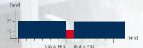
Um die ungestörte Verbindung innerhalb des Systems sicherzustellen, arbeitet die ABUS Secoris im Frequenzband von 868,0 MHz bis 868,5 MHz. Innerhalb des Bandes können Sie zwischen 4 Frequenzen wählen. Die ABUS Secoris gibt hier eine Empfehlung zur optimalen Frequenz. Innerhalb einer Installation mit mehreren Funkerweiterungen können auch unterschiedliche Frequenzen ausgewählt werden.
