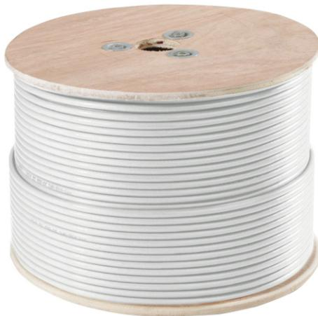
Le câble vidéo combiné relie les différents composants entre eux et assure une bonne transmission des données. Les deux câbles électriques intégrés ( $2 \times 0,75 \text{ mm}^2$ ) alimentent en courant les appareils raccordés. La résistance des câbles s'élève à 75 ohms. Le câble coaxial existe dans des longueurs de 50 mètres (KA9002), 100 mètres (KA9001) et 250 mètres (KA9000).
