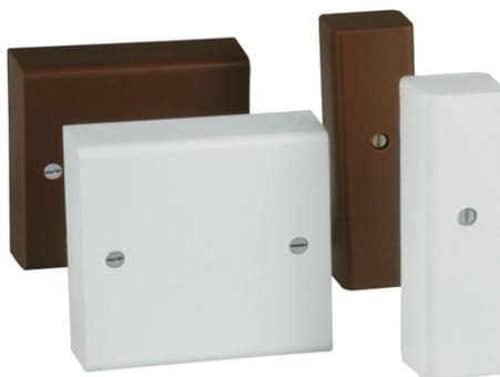
Grâce au répartiteur à visser, vous pouvez réaliser un câblage net. Vous devez installer un répartiteur aux endroits névralgiques de votre bâtiment, surtout lors de l'installation de plusieurs éléments de commande et détecteurs. Le répartiteur à visser à monter en saillie est protégé du sabotage par son contact de couvercle. Il existe en blanc et en marron, avec double raccordements à visser en 5 (VT5000) ou en 8 (VT5100). Les répartiteurs à visser sont en plastique antichoc.
