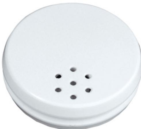
Le détecteur d'eau ABUS est un détecteur technique. Il réagit à l'eau et aux autres liquides. Dès que les capteurs du détecteur entrent en contact avec de l'eau, ce dernier donne l'alarme à l'aide d'un appareil de signalisation intégré. Il est donc possible de détecter des dégâts provoqués par une rupture de tuyauterie ou l'éclatement des tubes flexibles des machines à laver la vaisselle et le linge, et d'éviter le pire grâce à une intervention rapide.
