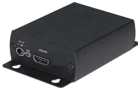
Ce convertisseur est destiné à convertir le signal d'une caméra HD-SDI en une interface HDMI. Vous avez donc la possibilité de brancher une caméra HD-SDI directement sur l'écran équipé d'une entrée HDMI (1080p25). Le convertisseur dispose également de deux sorties HD-SDI (BNC) qui sont amplifiées. Le signal HD-SDI peut ainsi être transmis à un enregistreur numérique HD-SDI ou à un écran/convertisseur HD-SDI.
