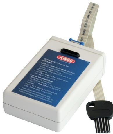
L'appareil de transfert est une interface bidirectionnelle entre les verrous électroniques et le PC de gestion. Il transfère les données des verrous électroniques vers le PC mais également les événements déjà répertoriés. Il peut également attribuer également des codes d'accès (fermeture-activation) aux systèmes de fermeture.
