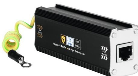
Grâce à la protection contre la surtension, protégez vos caméras, enregistreurs vidéo réseau ou autres appareils réseau de manière fiable et économique contre les tensions électriques trop élevées, par ex. contre les éclairs ou les décharges statiques. Vous évitez ainsi que vos appareils coûteux ne s'endommagent. La protection contre la surtension est conforme à la norme CEI61643-21: 2000
