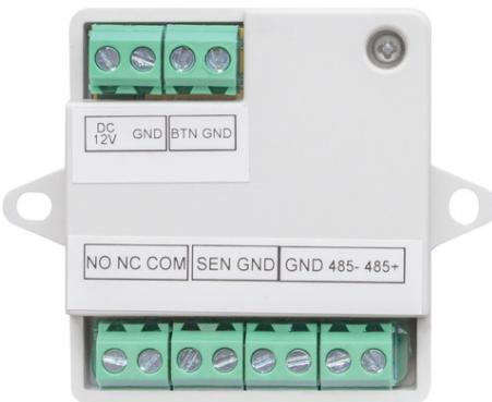
Le module de sécurité est utilisé comme protection supplémentaire contre les manipulations pour le portier ABUS ou le terminal de reconnaissance faciale, afin d'empêcher l'ouverture non autorisée de la porte, en cas de forçage du portier. Le raccordement d'une gâche électrique, d'une serrure motorisée ou d'un cylindre de fermeture électrique est possible (relais max. 2 A @ 30 VDC / 0,5 A @ 125 AC).
