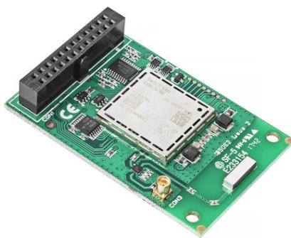
Trasmissione aggiuntiva di messaggi di allarme tramite rete di telefonia mobile
