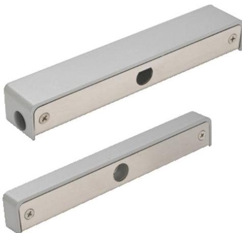
Alloggiamento e controparte per l'elemento di chiusura AZSE10000 e AZSE10100, se non è possibile montare l'elemento di chiusura nel telaio della porta. Il magnete per l'attivazione del contatto magnetico interno SpE e il contatto magnetico supplementare sono inclusi nella controparte.
