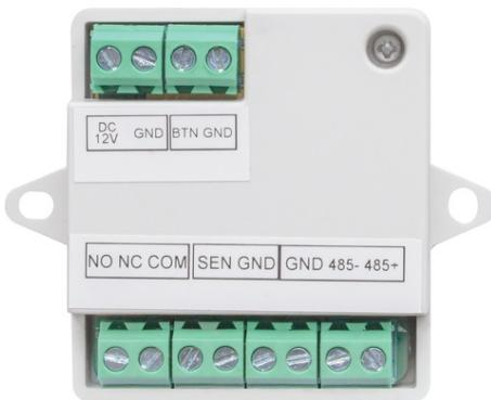
Il modulo di sicurezza viene utilizzato come protezione aggiuntiva contro le manomissioni del posto esterno ABUS o del terminale di riconoscimento facciale per impedire l'apertura non autorizzata della porta in caso di apertura forzata del posto esterno. È possibile collegare un apriporta elettrico, una serratura motorizzata o un cilindro di chiusura elettrico (relè max. 2 A @ 30 VDC / 0,5 A @ 125 AC).
